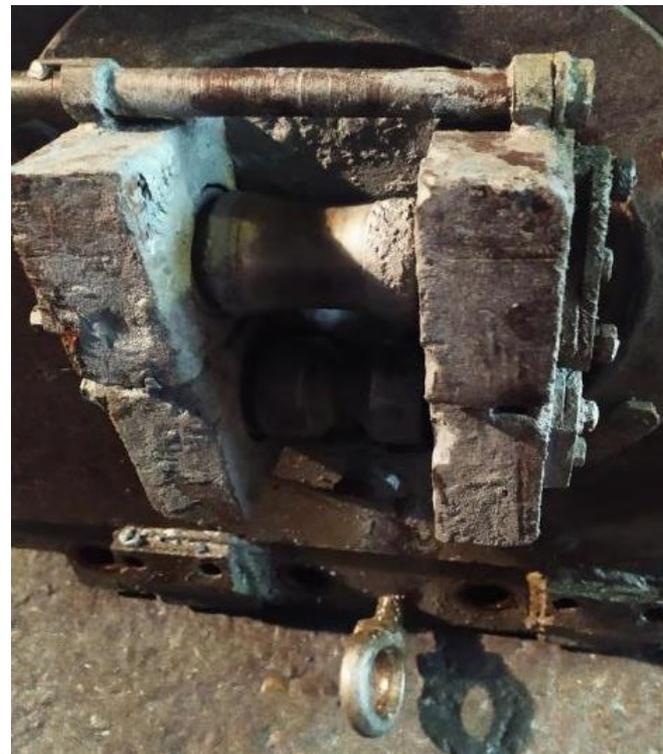
Проводка вводная клетей находится на входе каждой клетки. В роликах проводки имеют повышенный износ подшипники шариковые радиальные закрытые 180202 (20,67 руб/шт), выходят из строя в результате попадания СОЖ+алюминиевая пудра в подшипник, вымывания смазки, абразивного износа.
